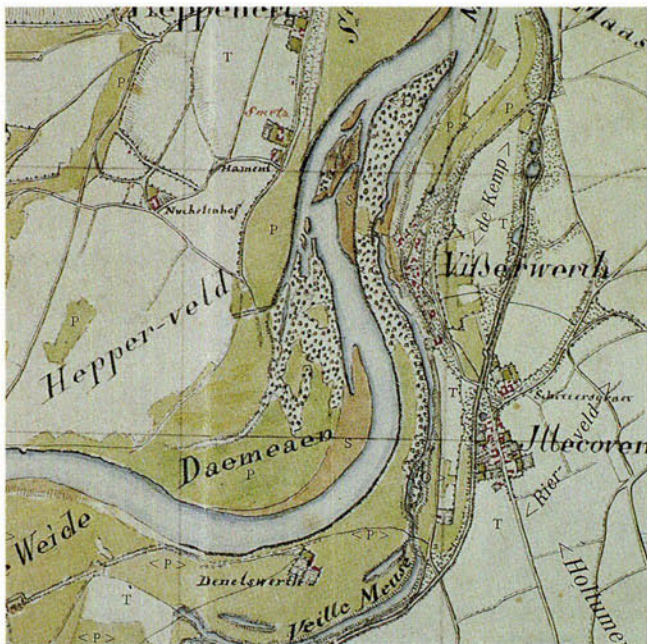
FIGUUR 4 Rivierkaart uit 1804 waarop de sterke sedimentatie in de verbreding na de flessenhals van Vissersweert duidelijk is te zien. De Maas heeft in dit deel een verwildeerde loop.
